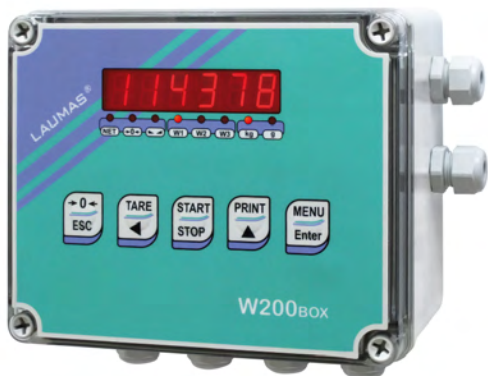
W200BOX - Versione in cassetta stagna IP67 in policarbonato. Dimensioni 170x140x95mm, quattro fori di fissaggio Ø4 mm (interasse fori 152x122mm). Sei pressacavi PG9 (tipo "P").
